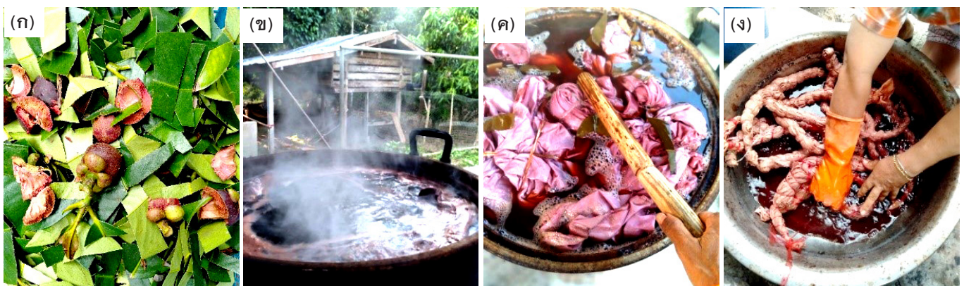
ภาพที่ 6 การทำผ้ามัดย้อมด้วยสีธรรมชาติจากผสมสีดอกดาวเรือง ใบมังคุด และเปลือกมังคุด (ก) การหั่นใบมังคุดเพื่อเตรียมสกัดสี (ข) การต้มน้ำย้อมผ้า (ค) การย้อมผ้าในน้ำสี และ (ง) การแช่ผ้าในน้ำปูนใสสลับกับน้ำมังคุด
